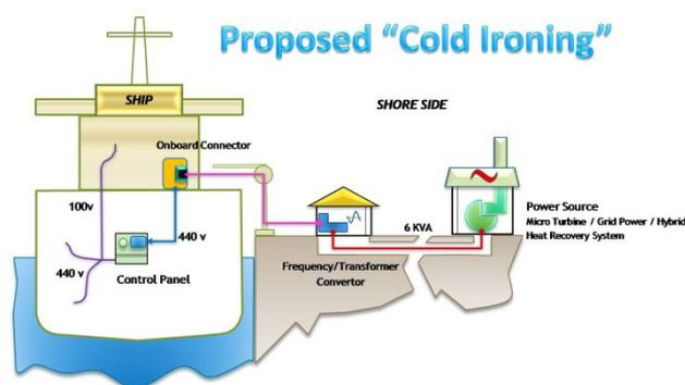
*Figura 3: esempio di sistema cold ironing.*
